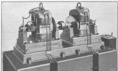
Abb. 38. Maschinengruppe zur Spannungsteilung. Von der Compagnie de l'Industrie électrique (Brevets Thury) in Genf.
