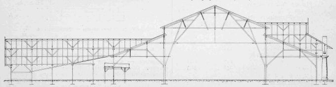
Abb. 3. Querschnitt durch die Mitte der Halle und die Nebenräumlichkeiten. Masstab 1:400.
