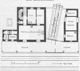
Abb. 19. Station St. Anton. Grundriss vom Erdgeschoss. — Masstab 1:400.
