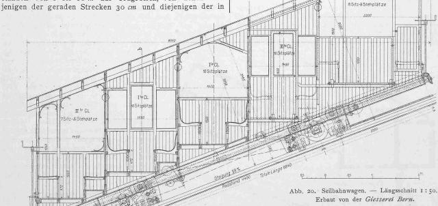
der Kurve liegenden Strecken 42 cm Durchmesser im Laufring haben. Der Laufring besteht aus weichem Gusseisen und ist durch gepresste Blechwangen gehalten, die so angeordnet sind, dass der Ring bei erfolgter Abnutzung auf dem Platze ersetzt werden kann.
