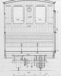
Abb. 21. Seilbahnwagen. — Querschnitt. I: 50.
