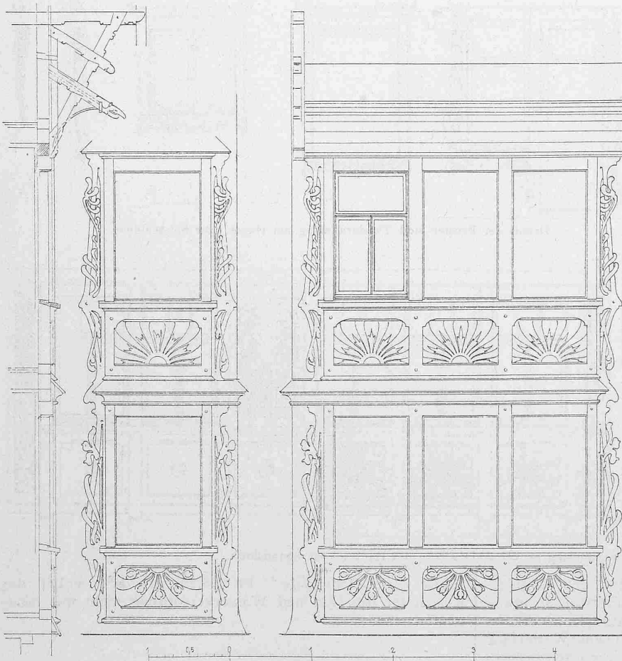
Details der Holzverkleidung an der Südwestecke des Hauses «zum Flüeli».
