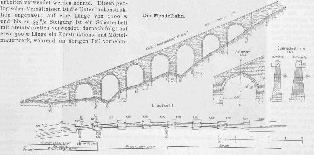
Abb. 10. Viadukt von 100 m Länge. — Grundriss und Ansicht 1:1000. — Details 1:500.
