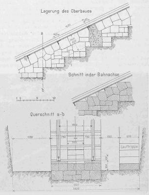
lagsplatten die Bremskraft auf. Jene 6000 kg werden auf Abb. 13. Details zum Oberbau der Seilbahnstrecke. — Masstab 1:50.
