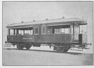
Abb. 6. Anhängewagen der Adhäsionsstrecke.
