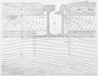
Abb. 11. Querschnitt durch Brückenbelag und Strassenbahngeleise. — 1:5.
