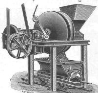
Für Bauunternehmer als Beton- und Mörtelmaschine.
