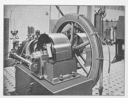
Abb. 16. 10 P. S.-Gasmotor von Escher Wyss & Cie. — Rückansicht.
