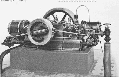
Abb. 14. Dampsmaschine von C. L. Brown mit angenähertem Massenausgleich von der Maschinenfabrik Oerlikon.
