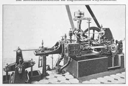
Abb. 13. Luftpumpenmaschine, Gebaut von der *Maschinenfabrik Burckhardt A.-G.* in Basel.
