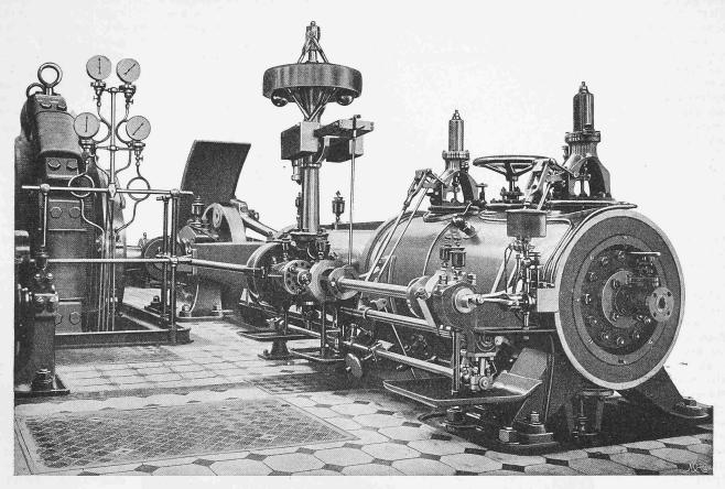
Abb. 7. Die dreistufige Dampsmaschine. - Hochdruckseite, gebaut von Gebrüder Sulzer in Winterthur.
