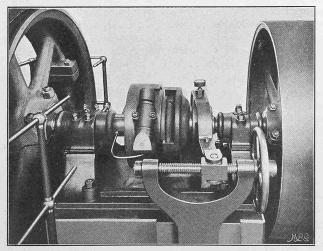
Abb. 10. Hydraul. Dynamometer von J. Amsler-Laffon in Schaffhausen.
