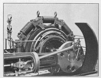
Abb. II. Hochdruckkurbelscheibe.
