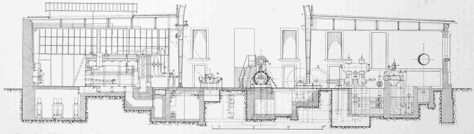
Abb. 5. Querschnitt durch das Kesselhaus und den mittlern Teil der Maschinenhalle mit Ansicht der östlichen Wand gegen das Zeichensaalgebäude. — Masstab 1:250. — (Legende siehe Seite 188.)
