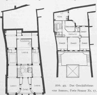
Grundrisse vom Erdgeschoss des Vorderhauses und vom I. Stock des Hinterhauses. — Masstab I:400.
