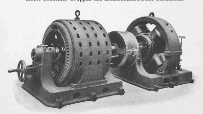
Abb. 4. 65 kw Dynamo Typ IXa, 440—600 Volt, 148—109 Ampère, gekuppelt mit 100 P. S. Drehstrommotor Typ 3065, 6000 Volt 25 Cycles.
