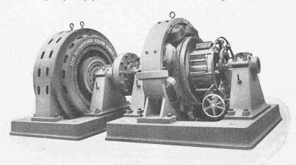
Abb. 1. 500 kw Dynamo Typ G. 80, 440—600 Volt, 1140—830 Ampère, gekuppelt mit 600 kw Drehstrommotor Typ 8084, 6000 Volt 25 Cycles.
