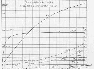
steerlaufcharakteristik, 9 = Wirkungsgrad; Varm + Ohmische Verluste im Armaturkupfu oli al = Uebergangsverluste am Kollektor, VK.R. = Mechan. Verluste am Kollektor; VF.E = V ysteresis & Wirbelströme, VErr = Verluste im Magnet kupfer & im Nebenschlussergulator, VR-V = Verluste durch Lagerreibung und Ventilation.
