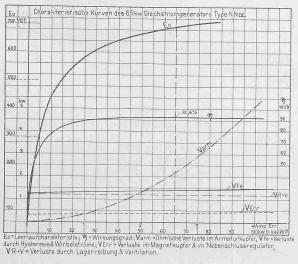
2. Ohmsche Widerstände der Wicklungen: Armatur: 0,011 Ohm bei 60 °C. einschl. Uebergangswiderstand. Feld: 250 Ohm bei 20°C., 290 Ohm bei 60°C. gemessen. 3. Eisen-, Reibungs- und Ventilations-Verluste:
