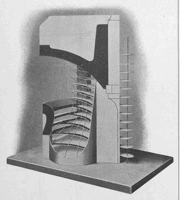
Abb. 13. Demonstrations-Modell für die Schaufelung.
