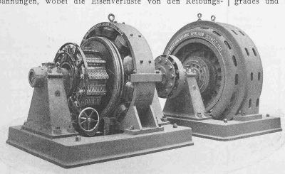
Abb. 2. 500 kw Dynamo Type G. 84, 220—300 Volt, 2270—1670 Ampère, gekuppelt mit 500 kw Drehstrommotor Typ 8088, 6000 Volt 25 Cycles.
