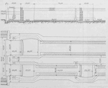
Abb. 30. Zwillings-Schleusen. — Untere Torkammern. — Masstab 1:1500.
