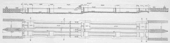
Abb. 25. Zweistufige Zwillings-Schleusen. — Grundriss und Längenschnitt. Masstab 1:4000.
