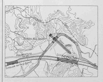
Abb. 36. Staudamm bei Bohio. — Vorschlag von Ing. Sonderegger.
