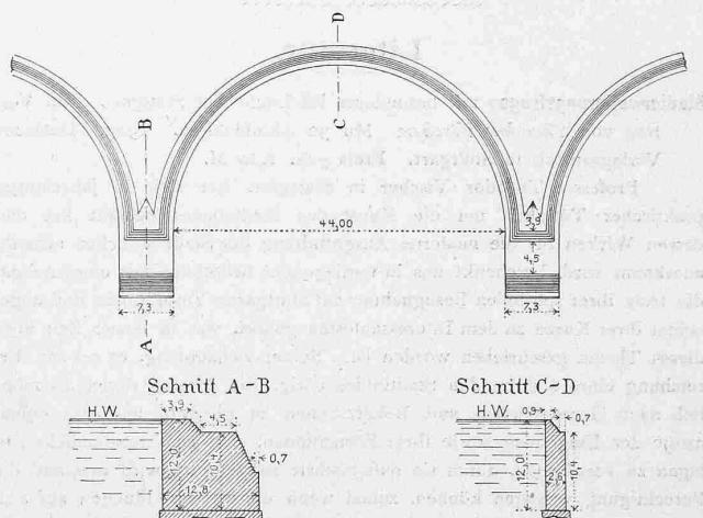
in der vorstehenden, dem «Eng. Record» entnommenen Abbildung dargestellt ist, liegt in der Mitte. Die Mauer besitzt an der Talseite einen Überfall, doch fliesst bei heftigen Regenfällen das Wasser einige Centimeter hoch über die ganze Mauerkrone ab.
