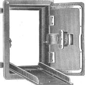
Kamintür geoffnet, mit herabfallender Schutzklappe. Obige Türe aus Schmiedeisen ist von grösster Wichtigkeit für Architekten u. Baumeister. Absolute Unmöglichkeit, den Schlüssel abzuziehen, bevor die Türe vollständig geschlossen ist. Wird entweder mit innerer Schutztür od, herabfallender Schutzklappe versehen.
