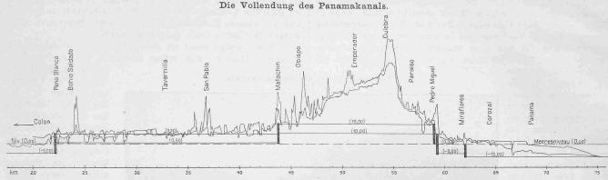
Abb. 13. Längenprosil des Panamakanals mit Schleusen. Höhe der Scheitelsohle 10 m. — Masstab für die Längen 1:300000, für die Höhen 1:3000.
