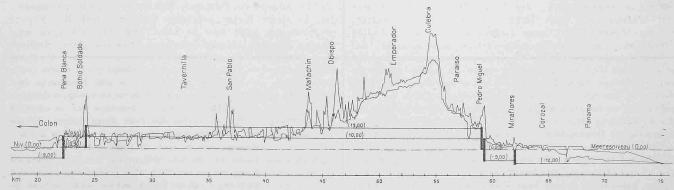
Abb. 15. Längenprofil des Kanals mit Schleusen und Stausee. Höhe der Scheitelsohle 10 m. — Masstab für die Längen 1: 300 000, für die Höhen 1: 3000.
