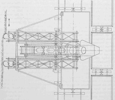
Summe von 77 Millionen Abb. 21. Bagger mit rotierenden Extraktoren, System Sonderegger. — Grundriss. — 1:100. rechteckigen, 7—8 m lan-
