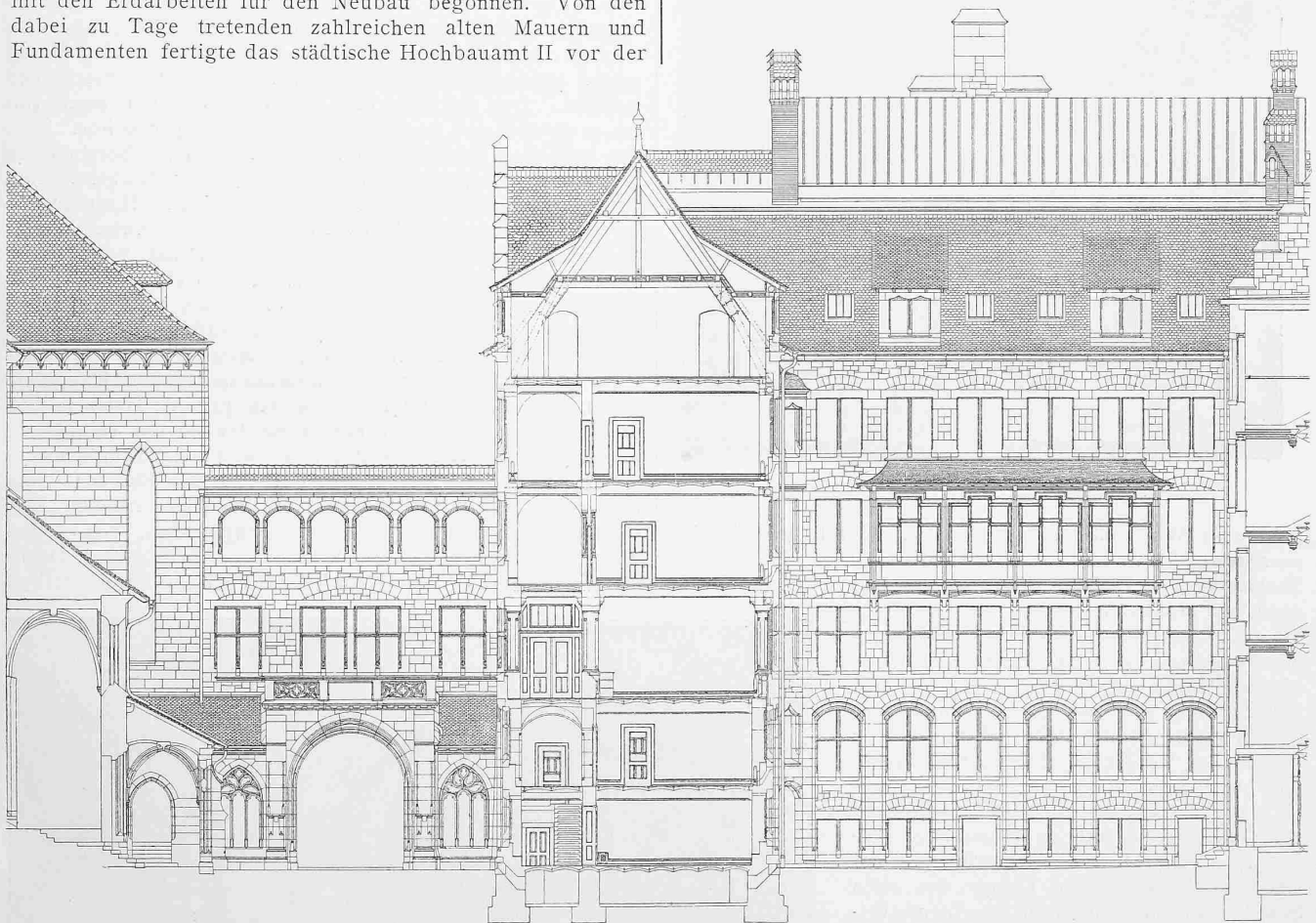
Abb. 11. Schnitt von der Fraumünsterkirche zur Kappelegasse durch die Höfe II und I. — Masstab 1:250.
