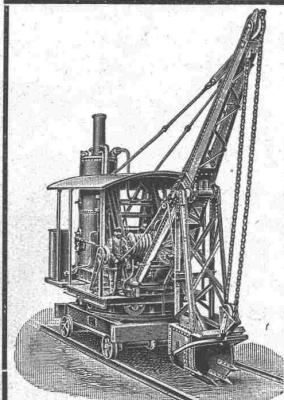
zum Abgraben von Erdmassen und Verladen derselben in Wagen, auch als **Krahn** zum Heben von Lasten und als **Greifbagger** verwendbar.
