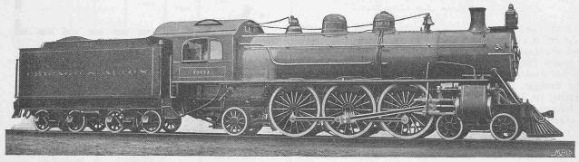
Abb. 8. Die 3/6 gekuppelte Schnellzuglokomotive der Chicago & Alton-Bahn. Gebaut von den *Baldwin Works* in Philadelphia.
