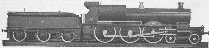
Abb. 5. Die  $^3/_5$  gekuppelte Schnellzuglokomotive der Great-Western-Railway. — Swindon.
