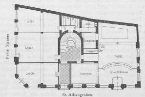
Abb. 21. Grundriss vom Erdgeschoss. — Masstab 1:400.
