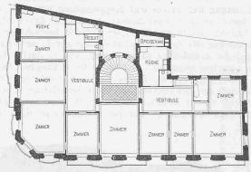
Abb. 19. Grundriss der Obergeschosse. - Masstab 1:400.
