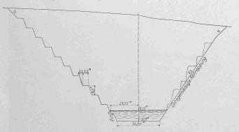
Abb. 6. Normalprofil im grossen Culebra-Einschnitt. — 1:2000.
