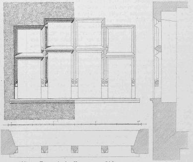
Abb. 7. Fenster in der Untergasse zu Biel. Masstab 1:40.
