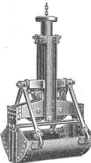
Diese Apparate dienen zum Aushub des Erdreichs aus Baugruben, Senkbrunnen u. s. w. Dieselben können durch einen gewöhnlichen Kran, event. auch durch eine Winde bedient werden.
