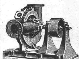
zum Fördern von schmutzigem und festen Bestandteile enthaltendem Wasser. Steine etc. zur Grösse von ein Drittel des Saugrohr-Durchmessers gehen durch dieselbe hindurch, ohne sich festklemmen zu können.
