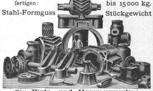
Walzund Hammerwerke: Spindeln, Muffen, Einbaustücke, Walzenständer, Kammwalzen, Zahnräder, Sättel, Hammerbäre etc. etc.
