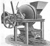
Für Bauunternehmer als Beton- und Mörtelmaschine.
