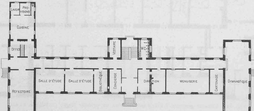
Fig. 23. Plan du rez-de-chaussée. — Echelle 1:600.
