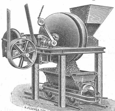
Für Bauunternehmer als **Beton- und Mörtelmaschine**.
