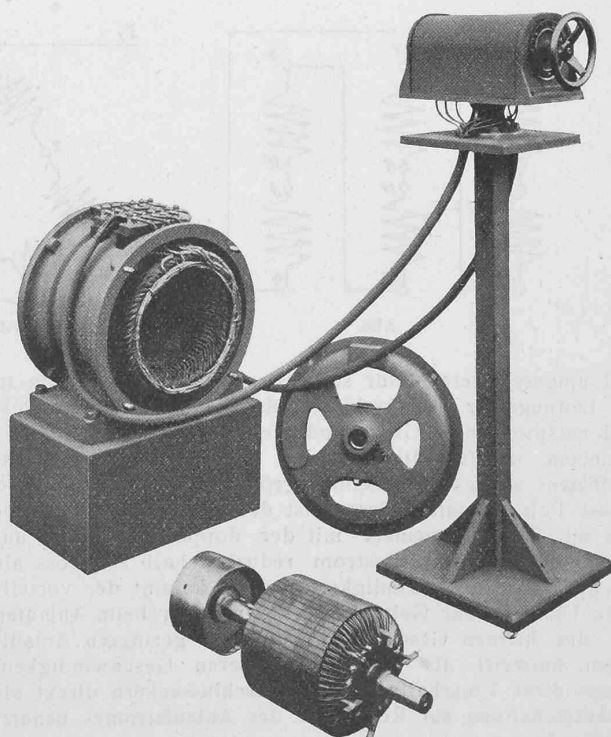
Abb. 9. Vierstufen-A-Motor, System Oerlikon. — Demontiert. Umdrehungszahl: 500, 750, 1000 und 1500. Leistung: 4—6 P. S.
