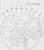
Abb. 3. Wickelungs- und Schaltungsschema für Drehstrommotoren mit zwei Geschwindigkeiten. Zwei- und vierpolig.
