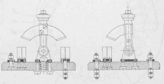
Abb. I. Polumschalter für zwei Geschwindigkeiten zu Drehstrommotoren von I bis 6 P. S.
