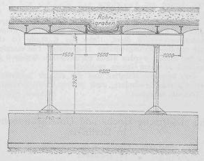
Abb. 27. Unterpflasterbahn, Längsschnitt.
