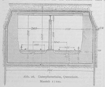
in Entfernungen von 25 m seitliche Nischen ausgespart worden; auch die zwischen den Pfeilern gelegenen Bankette dienen demselben Zwecke. Die Abführung des Tagewassers geschieht durch je in der Mitte der beiden Tunneltröge befindliche Ablaufkanäle.
