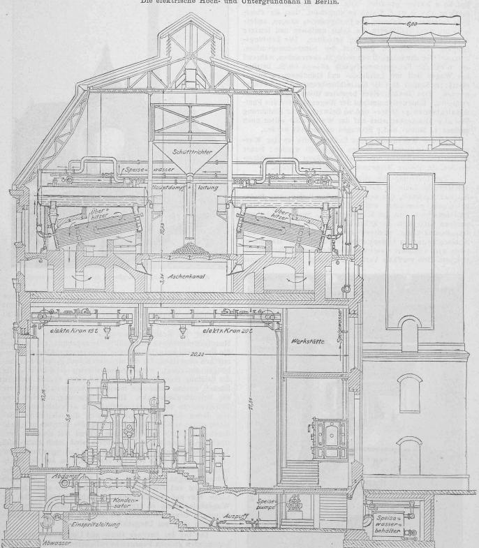
Abb. 38. Kraftwerk an der Trebbinerstrasse. — Querschnitt. — Masstab 1:150.
