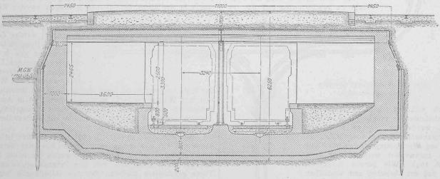
Abb. 30. Unterpflasterbahn. — Haltestelle Wittenbergerplatz. — Querschnitt. — Masstab I: 100.
