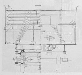
Abb. 5. Querschnitt des Tenders. — Masstab 1:40.
