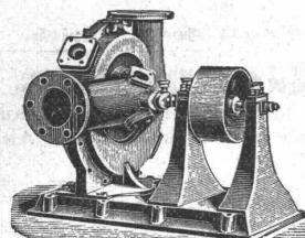
zum Fördern von schmutzigem und feste Bestandteile enthaltendem Wasser. Steine etc. zur Grösse von ein Drittel des Saugrohr-Durchmessers gehen durch dieselbe hindurch, ohne sich festklemmen zu können.
