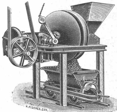
Für Bauunternehmer als Beton- und Mörtelmaschine.
