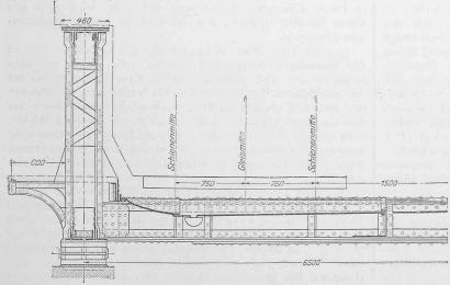
Abb. 12. Strassenüberbrückung. - Querschnitt. Masstab 1:40.
