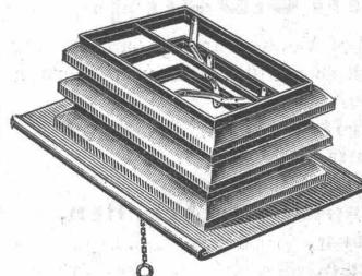
Bedeutend gröserer Ventilationseffekt durch parallel Hub der Rahmen, Oeffnen durch Hebelmechanismus mit Uebersetzung, Schliessen selbsttätig durch Eigengewicht, keine gleitende Reibung, kein Verrostern, kein Versagen des Mechanismus, Bedienung von jedem beliebigen Punkte aus ohne besondere Zugvorrichtung, vorzüglich zum Absaugen von Gasen, Staub, Dämpfen etc., an Einfachheit und unbedingter Zuverlässigkeit unübertroffen vor allen anderen Systemen. Verlangt ausführl. illustr. Prospekt von der
