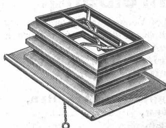
Bedeutend gröserer Ventilationseffekt durch parallel Hub der Rahmen, öffnen durch Hebelmechanismus mit Übersetzung, Schliessen selbsttätig durch Eigengewicht, keine gleitende Reibung, kein Verrostung, kein Versagen des Mechanismus, Bedienung von jedem beliebigen Punkte aus ohne besondere Zugvorrichtung, vorzüglich zum Absaugen von Gasen, Staub, Dämpfen etc., an Einfachheit und unbedingter Zuverlässigkeit unübertroffen vor allen anderen Systemen. Verlangt ausführl. illustr. Prospekt von der
