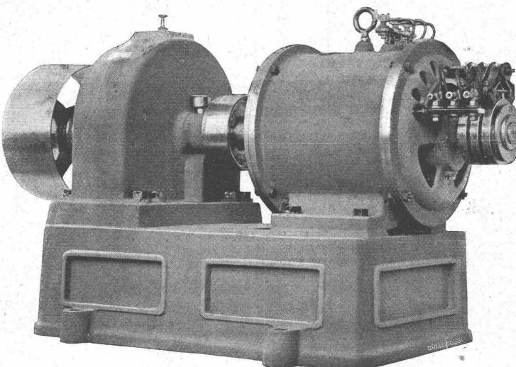
**Reduktionsgetriebe 1: 40 mittelst Pfeilrädern (Pat. C. Wüst)**
