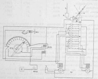
Abb. 12. Aigle-Leysin-Bahn. Schaltungsschema zur Ingangsetzung der Lokomotive.
