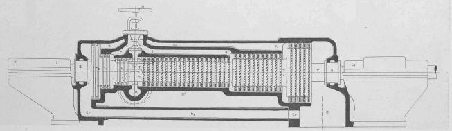
Abb. 1. Parsons-Dampfturbine von Brown Boyeri & Cie. — Schematischer Längenschnitt.
