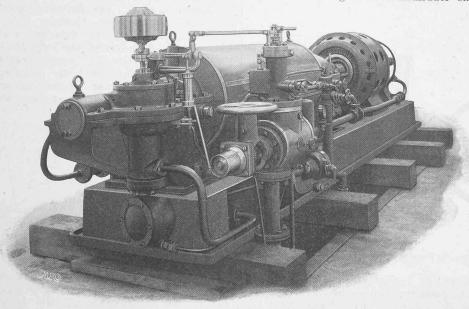
Abb. 4. Parsons-Dampfturbine. Erbaut von Brown, Boveri & Cie. in Baden (Aargau). Ansicht des Steuerungsmechanismus.
