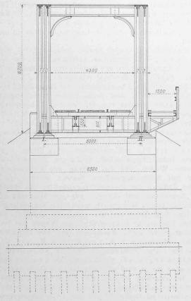
Abb. 10. Die Zihlbrücke. — Querschnitt am Auflager 1:125.
