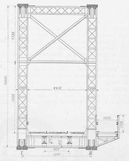
Abb. 11. Die Zihlbrücke. - Schnitt in der Mitte 1:125
