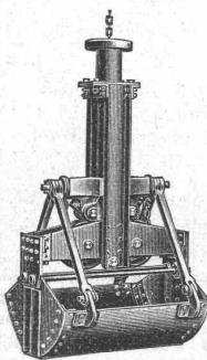
Diese Apparate dienen zum Aushub des Erdreichs aus Baugruben, Senkbrunnen u. s. w. Dieselben können durch einen gewöhnlichen Kran, event. auch durch eine Winde bedient werden.
