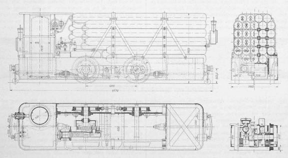
Abb. 85. Luftlokomotive für Betrieb «vor Ort». Ansicht und Schnitte. — Masstab 1:40.
