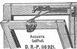
Die Konstruktion ist einfach und sinnreich. Ein federnder Hebel strebt den Fensterflügel zu öffnen, der Anzug der Schnur wirkt dem entgegengesetzt, und ein Haken, der beim Zuschlagen einschnappt, gibt den Flügel frei, wenn die Schnur von neuem angezogen wird. Es ist notwendig, dass durch die Verbreitung der Kenntnis dieses praktischen Apparates die enormen gesundheitlichen Vorteile, welche seine Anwendung mit sich bringen kann, gefördert werden.
