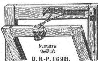
Die Konstruktion ist einfach und sinnreich. Ein federnder Hebel strebt den Fensterflügel zu öffnen, der Anzug der Schnur wirkt dem entgegengesetzt, und ein Haken, der beim Zuschlagen einschnappt, gibt den Flügel frei, wenn die Schnur von neuem angezogen wird. Es ist notwendig, dass durch die Verbreitung der Kenntnis dieses praktischen Apparates die enormen gesundheitlichen Vorzüge, welche seine Anwendung mit sich bringen kann, gefördert werden.
