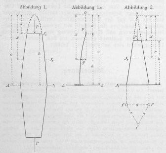
Für die entgegengesetzte Grenze, bei welcher das Paraboloid, wenn das Trägheitsmoment  $J_0$  der Kopffläche sich dem Werte des Trägheitsmomentes  $J_1$  der Grundfläche nähert, sich der Cylinderform anschmiegt, folgt für a=c-h
