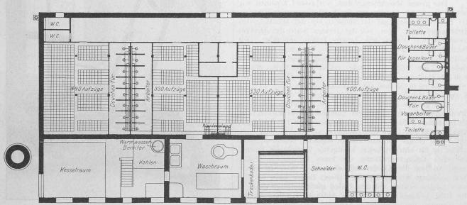
Abb. 71. Stationsgebäude auf der Nordseite. — Grundriss der Baderäumlichkeiten und der Wascherei. — Masstab 1:250.
