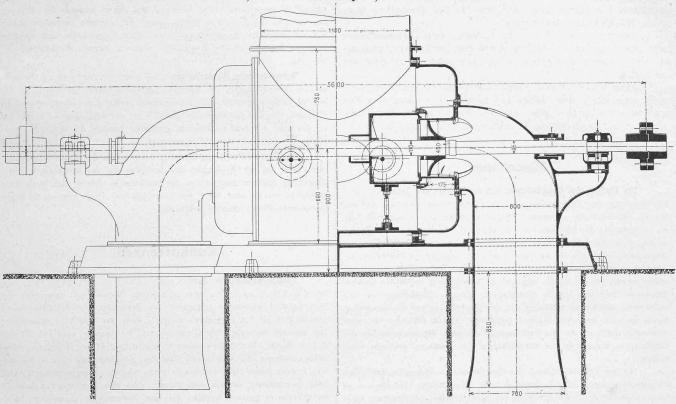
Fig. 18. Doppel-Herkules-Turbine. Masstab 1:25.
