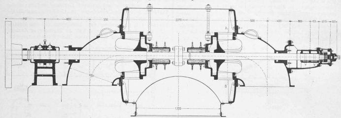
Fig. 12. Doppelturbine System «Hercule-Progrès». 1:30.
