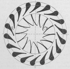
Fig. 14. Schnitt durch Laufrad, Leitrad und Regulierschieber der Doppelturbine «Hercule-Progrès». 1:15.
