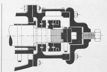
Fig. 12 a. Doppelspurlager zur Doppelturbine «Hercule-Progrès». Masstab 1:6.
