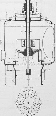
Fig. 10. Geschlossene Turbine "Hercule- Progrés", 500 P. S. - 1:50.
