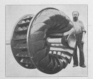
Fig. 9. Laufrad der Turbine «Hercule-Progrès».
