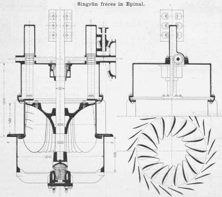
Fig. 8. Offene Turbine, System «Hercule-Progrès», 30 P. S. - I:25.
